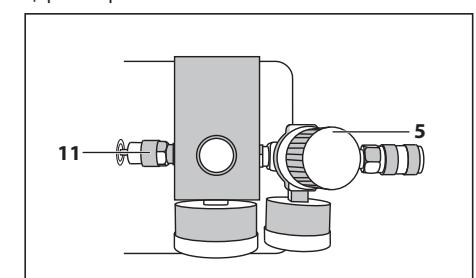
Перед началом работы отключите подачу давления, закрутив регулятор давления 5.
