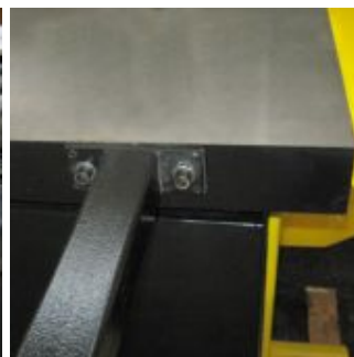
Литой чугунный стол отличается высокой жесткостью и точностью.
