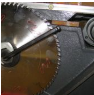
Чугунный корпус пильного узла.
