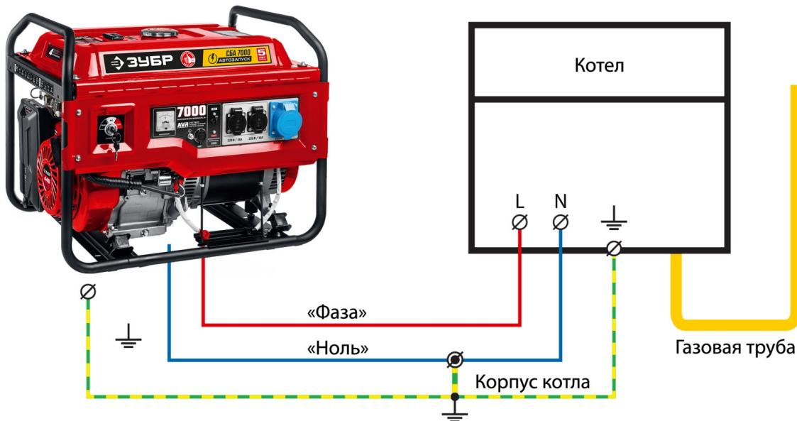
В силу особенностей конструкции автоматики газового котла, для ее правильного функционирования необходимо наличие у генератора ярко выраженных нуля и фазы.
