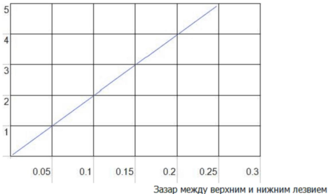
Для HQ01-1.6X2500B: макс. толщина реза 1.6 mm, поэтому наиболее универсальный зазор между верхним и нижним лезвиями устанавливается на 0.03~0.08 mm
