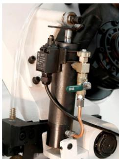
Пильная рама поднимается вручную, а опускается за счет механизма гидроразгрузки. Скорость опускания регулируется дросселем, расположенным на гидроцилиндре.
