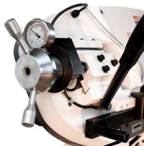
Натяжение пилы осуществляется маховиком с тензометром, что позволяет контролировать натяжение полотна и тем самым получать стабильный рез и продлить срок службы полотна.
