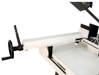
За надежное закрепление заготовки на станке отвечают тиски с механизмом быстрой фиксации. Они приводятся в движение маховиком и надежно фиксируют заготовку.
