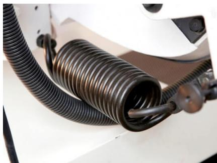
Легкость подъема рамы обеспечена за счет компенсирующей пружины.
