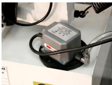
Станок оснащен системой подачи СОЖ с удобно расположенной емкостью и отдельным регулированием расхода охлаждающей жидкости.
