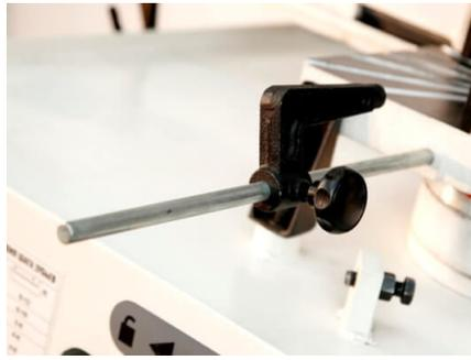
Боковой упор позволяет быстро выставить заготовку на нужный размер и получать детали с высокой степенью повторяемости.
