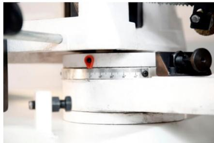
Metal Master BSM-250 имеет возможность поворота пильной рамы(влево/вправо) на угол  $\pm 60,45$  градусов.
