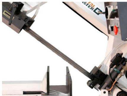
Перпендикулярность полотна обеспечивается за счет направляющих. Вылет можно изменять под размеры заготовки.
