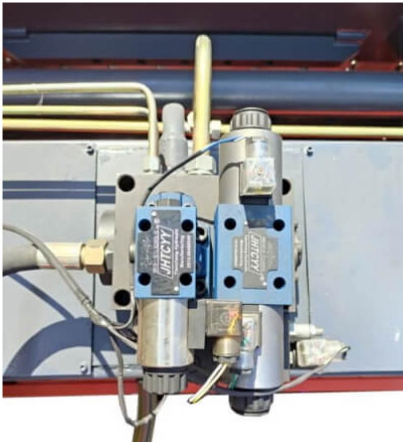
**Гидравлическая система бренда Rexroth расположена на верхней части станка**
