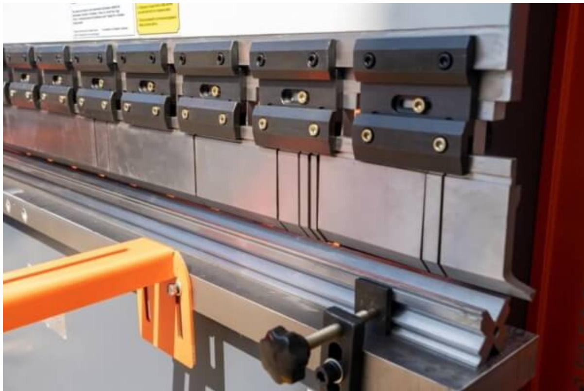
**Станок оснащен сегментным верхним инструментом.**
