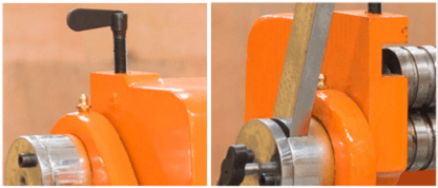
Кривошипы подлежат смазке смазочным шприцем по мере необходимости
