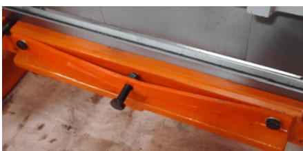
Система регулировки антипрогиба матрицы исключая прогиб
