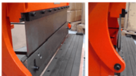
Высота сегментов – 103мм, глубина матрицы (входа пуансона в матрицу) – 10мм
