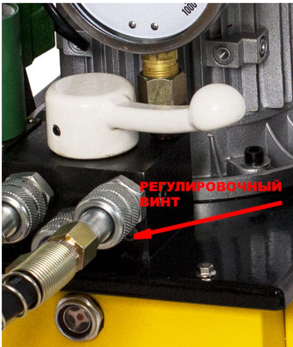
На лицевой части гидравлического блока управления 2 имеется **регулировочный винт** 14 с контргвинтом для настройки предельного уровня рабочего давления создаваемого маслостанцией (винт с внутренним шестигранником расположенный рядом с БРС 18). Штатно давление маслостанции настроено на **600-700**
