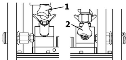
Рис.1 (1 - винт регулировки давления; 2 - винт сброса давления)
