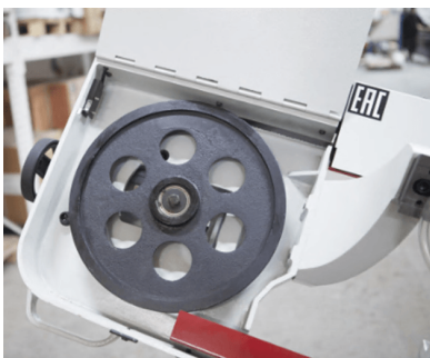
Предохранительный датчик при поднятой крышке рамы (фото №1).
