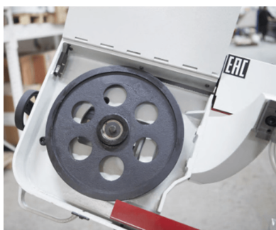
Предохранительный датчик при поднятой крышке рамы (фото №1).
