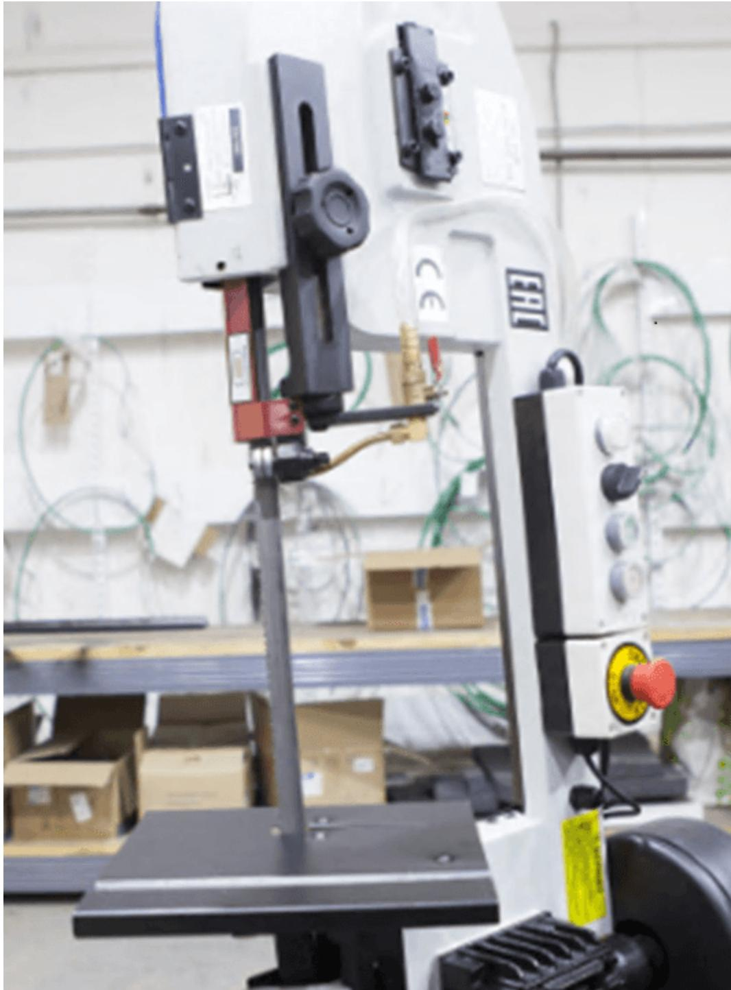
Пильную раму можно установить в вертикальном положении - для резки небольших изделий из дерева, пластика и других заготовок из мягких материалов (для которых не требуется фиксация в тисках во время пиления), при этом станок обязательно должен крепиться к полу. В стандартной комплектации имеется небольшой стол для ручной подачи заготовок, который крепится к раме в вертикальном положении.
