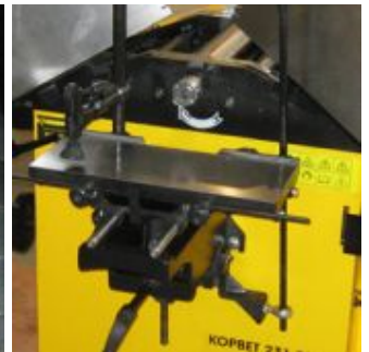
Направляющая планка имеет наклон до 45гр
