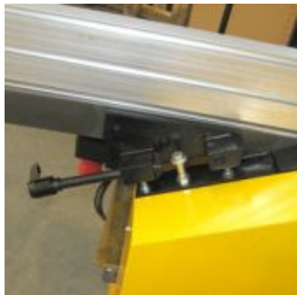
Быстрый и удобный переход из режима строгального станка в режим рейсмуса.
