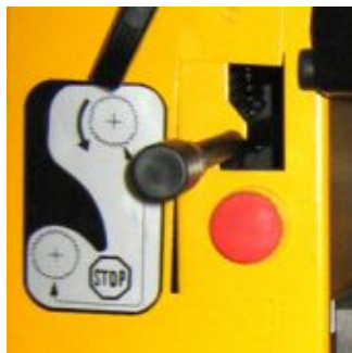
В режиме строгания предусмотрено отключение протяжных роликов.
