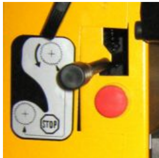
В режиме строгания предусмотрено отключение протяжных роликов.
