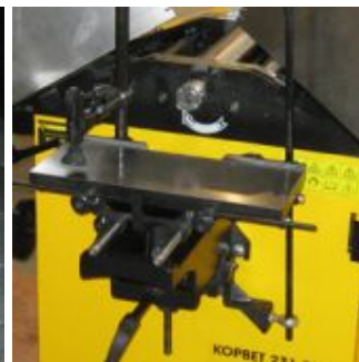
Направляющая планка имеет наклон до 45гр
