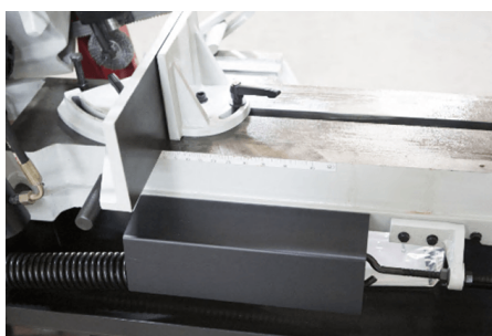
Съёмный сливной бачок. При снятии бочка с тумбы станка – под бочком находится полость для хранения (при транспортировке) ограничителя подачи листа.
