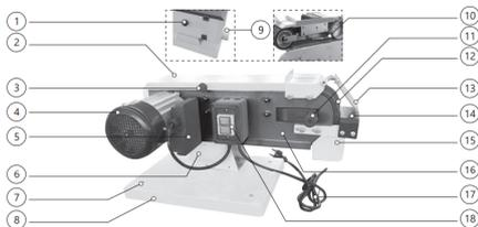
Рисунок 1. Основные элементы модели BSM-48AT.
