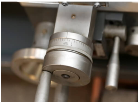
Цена деления лимба поперечной подачи – 0,1мм.
