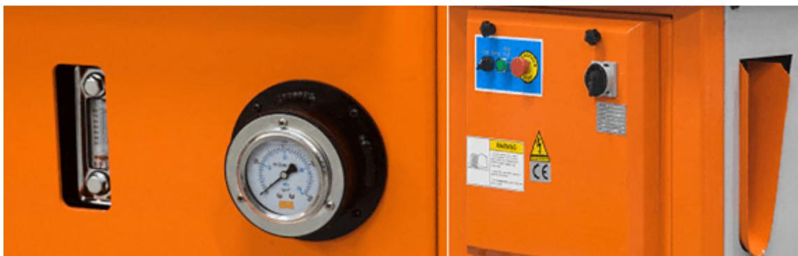
Датчик уровня масла; датчик давления гидравлической системы; контрольная панель; контейнер вывода стружки вниз.
