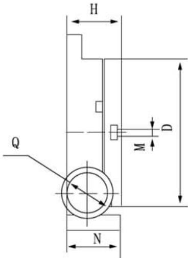
Поворотный стол **Metal Master СПГВ 200** является одним из основных аксессуаров для увеличения функциональных возможностей фрезерных станков. Он используется для добавления вращательного движения в процессы растачивания, фрезерования, подрезки торца и т.д. на фрезерном станке. Конструкция стола позволяет выполнять на нем комплексные задачи.
