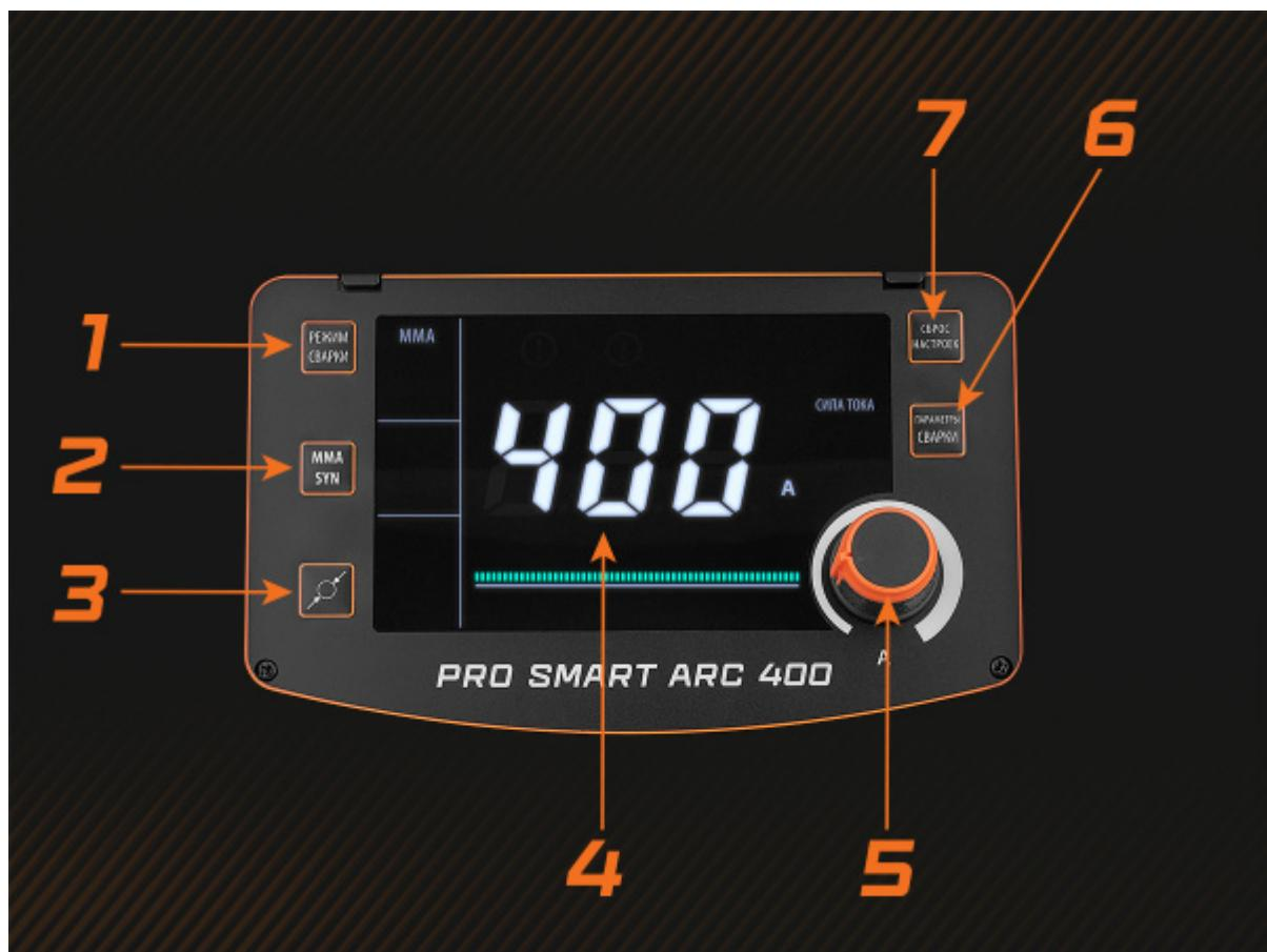
На лицевой панели расположен цветной LED дисплей (4), на котором отображаются все установленные параметры сварки. Настройка аппарата осуществляется с помощью регулятора (5), кнопки переключения режимов сварки MMA и TIG DC (1), включения и отключения синергетического режима аппарата (2), выбора диаметра электрода (3), параметров сварки для ручного режима (6) и сброса параметров настроек (7).
