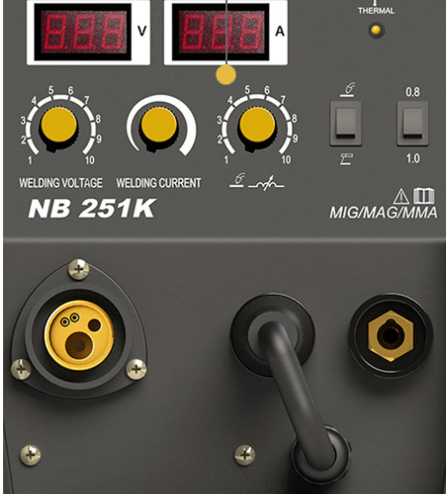
**Режим MIG/MAG** – Для сварки углеродистых сталей, хромоникелевых нержавеющих, алюминия и его сплавов, отличное формирование сварочного шва, и полный контроль дуги, высокая точность и повторяемость результатов сварки.
