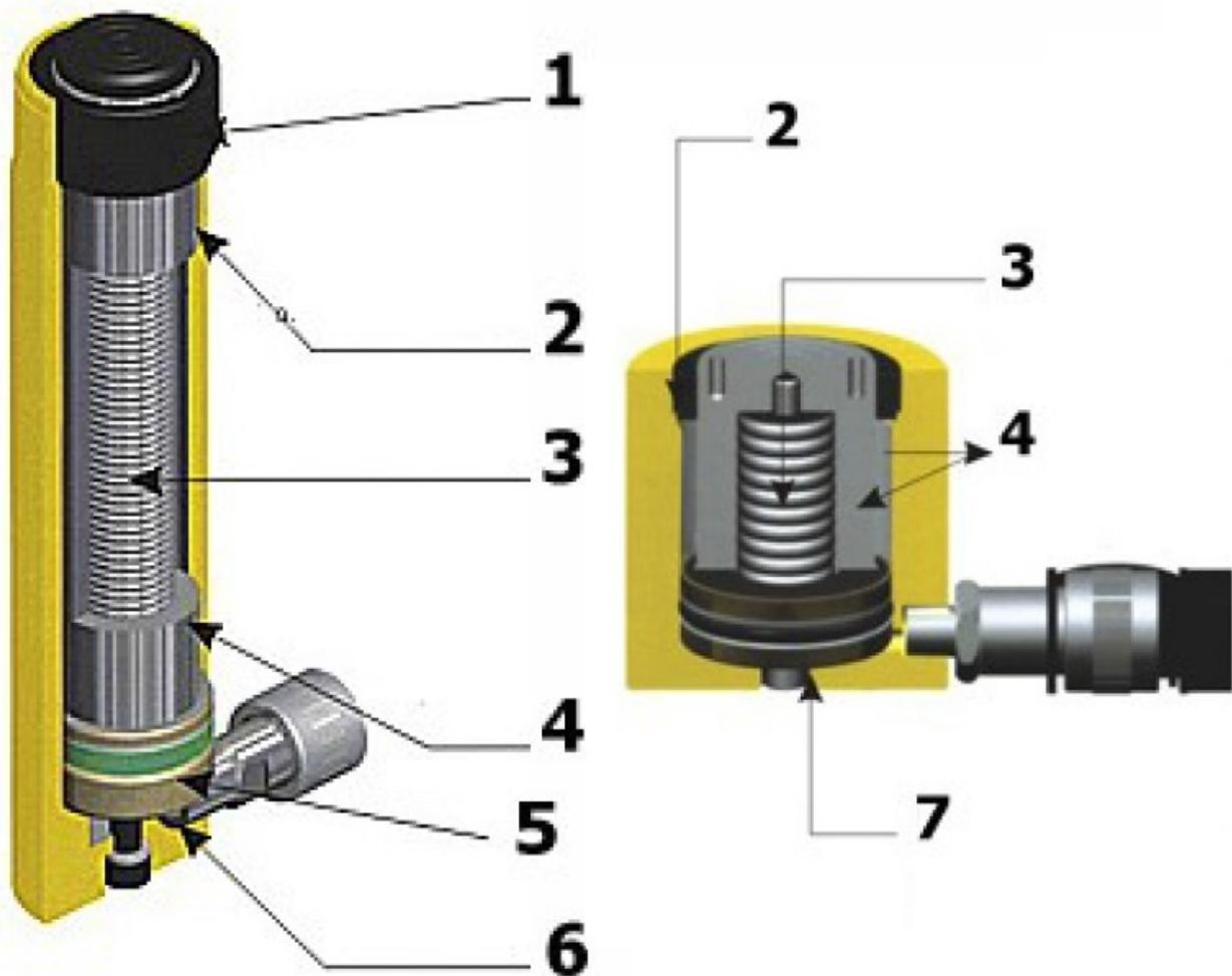
1. Твердая подложка (используется во избежание поломки плунжера в случае перегрузки).
