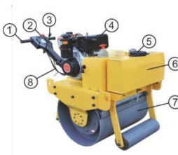
1 – рукоятка; 2 – рычаг реверса; 3 – рычаг газа; 4 – двигатель; 5 – бак для гидравлического масла; 6 – бак для воды; 7 – вибрационный валец; 8 – передающий кабель
