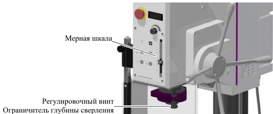
Рисунок 4-12: Ограничитель глубины сверления
