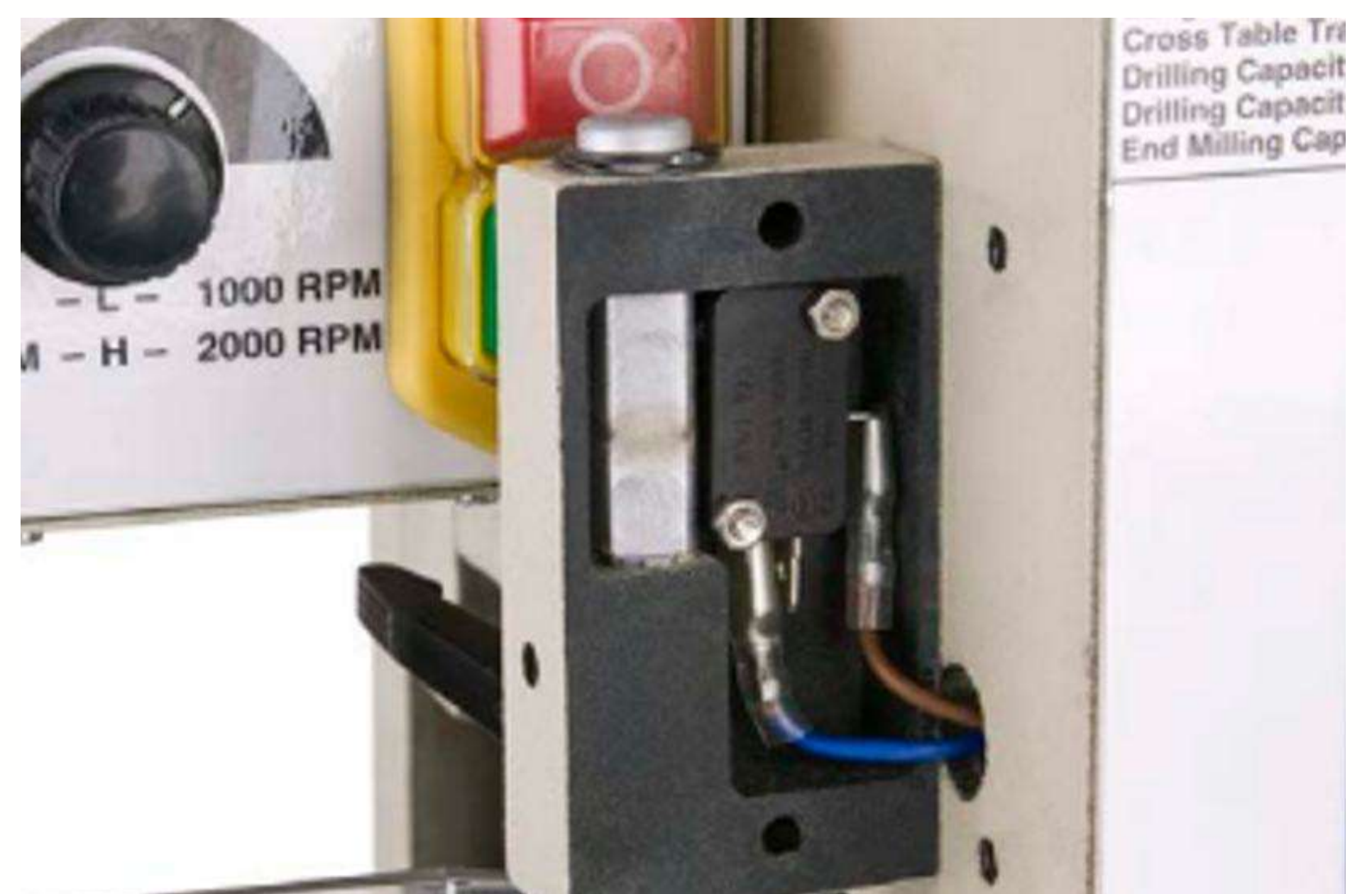
Концевой выключатель защитного кожуха (рис. 50)
