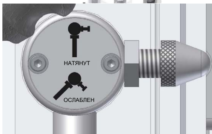
рис.4-2: Натяжение клинового ремня рычага
