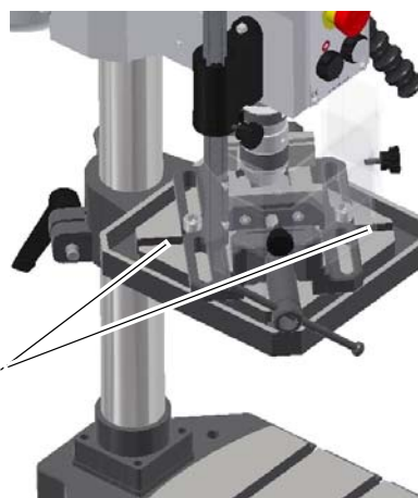
Рис.4-8: отверстие для гаек
