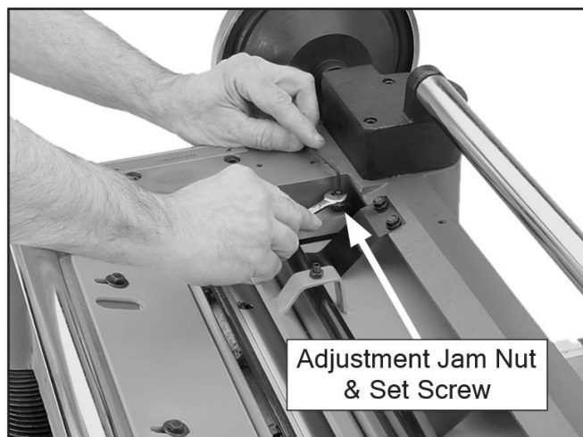
Рисунок 42. Пример регулировки высоты прижимной планки.
