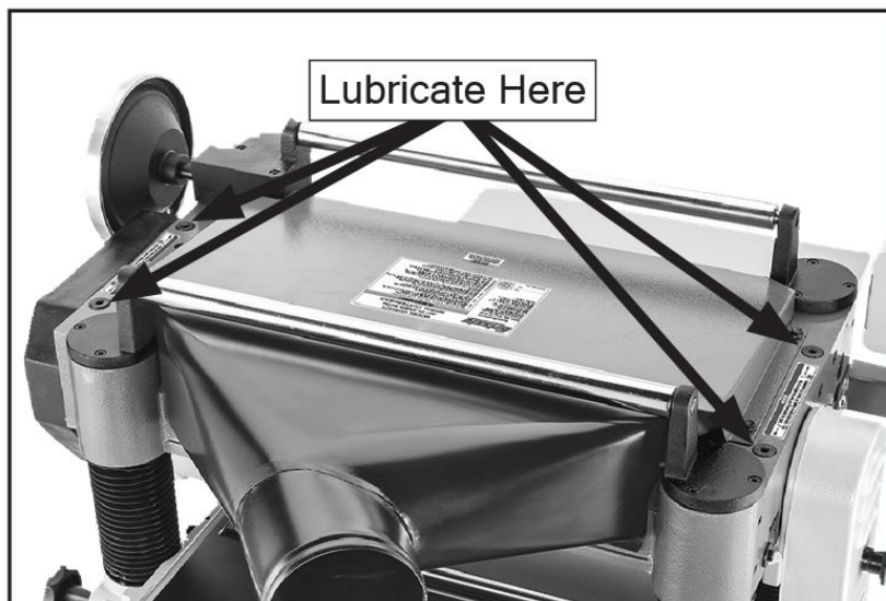
Рисунок 28. Места смазывания втулок подающих роликов.
