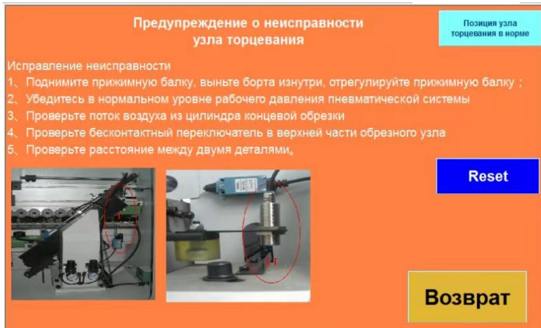
Рисунок 3-11 Аварийный сигнал при сбоях в работе торцовочных агрегатах
