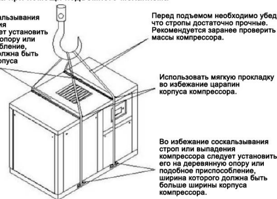
Транспортировка при помощи подъемного механизма
