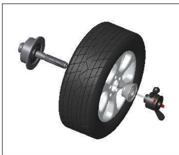
Главный вал – колесо – соответствующий конус (меньшей стороной вовнутрь) - быстрозажимная гайка
